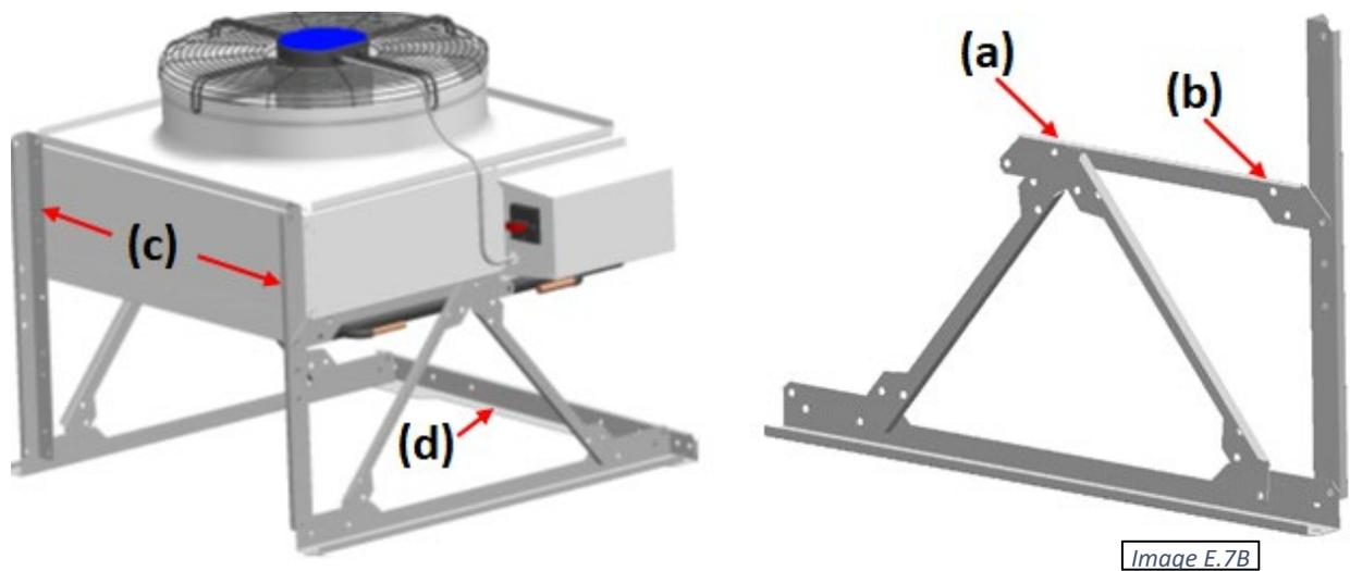
**Configuration de flux d'air horizontal** (l'équipement est monté sur une surface verticale telle qu'un mur). Dans ce cas, utilisez le même ensemble de montage que ci-dessus. Notez que les pieds de montage sont assemblés légèrement différemment.
