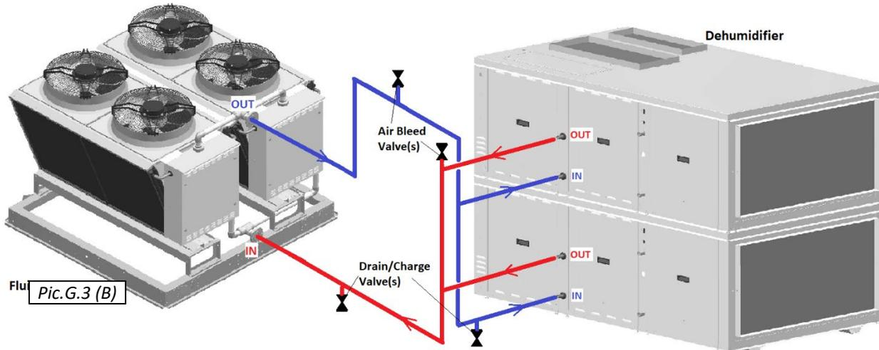
refroidissement des locaux (eau, glycol, etc.) – reportez-vous aux étiquettes de terminaison de tuyauterie respectives (IN/OUT), à l'étiquette principale (pour le dimensionnement des lignes) etc.
